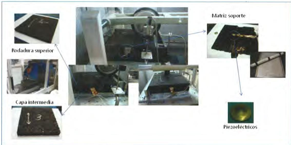
Figura 5. Visión completa del prototipo Wheel Track.
