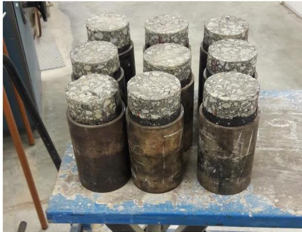
Figura 7-31. Probetas dobles parcialmente desmoldadas para su ensayo
