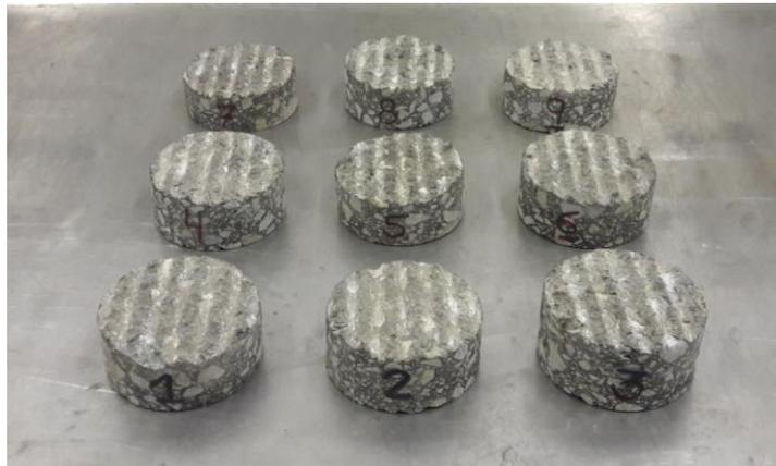
Figura 52. Testigos numerados y acondicionados en espesor
