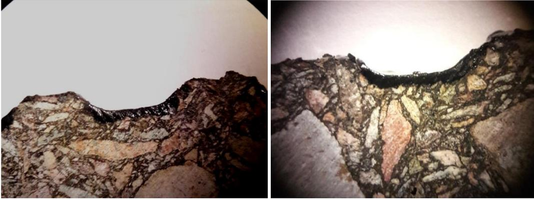
Figura 12. Disposición del riego lograda en laboratorio
