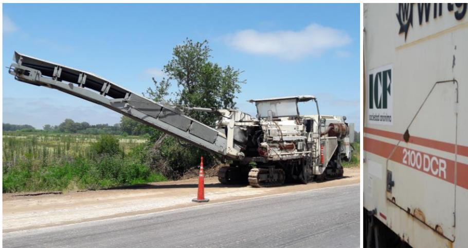
Figura 38. Equipo de fresado utilizado en la obra
