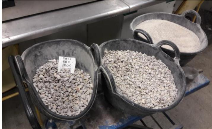
Figura 44. Agregados calizos utilizados en la experiencia
