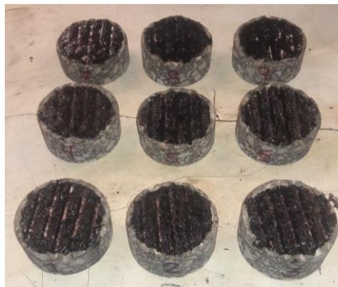
Figura 7-30. Testigos con el riego de liga aplicado
