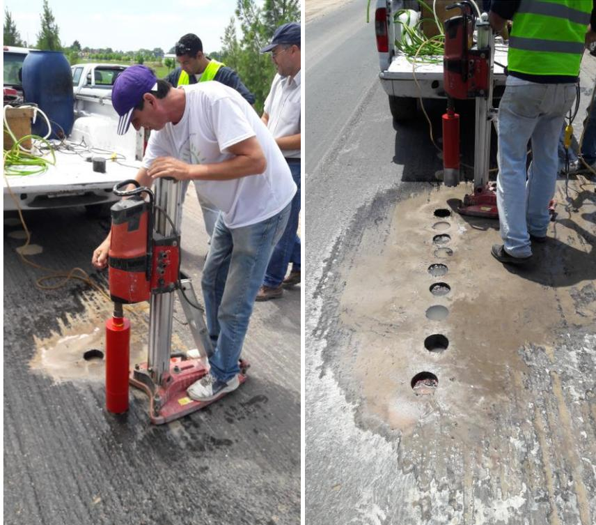
Figura 40. Extracción de testigos en el sector en análisis
