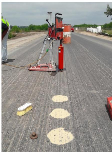
Figura 39. Determinaciones análogas al Ensayo de Parche de Arena efectuadas
