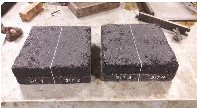
Figura 23. Probetas dobles prismáticas moldeadas
