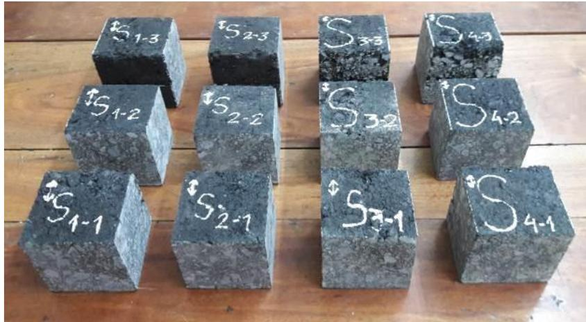
Figura 24. Probetas cúbicas generadas por aserrado para análisis a fatiga, Caso 4
