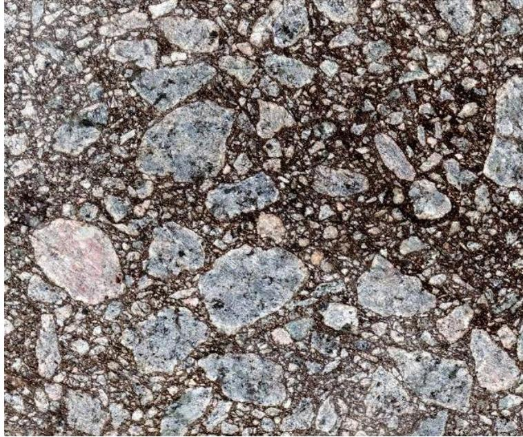
Figura 25. Escaneo en alta resolución de un corte en sentido transversal al fresado
