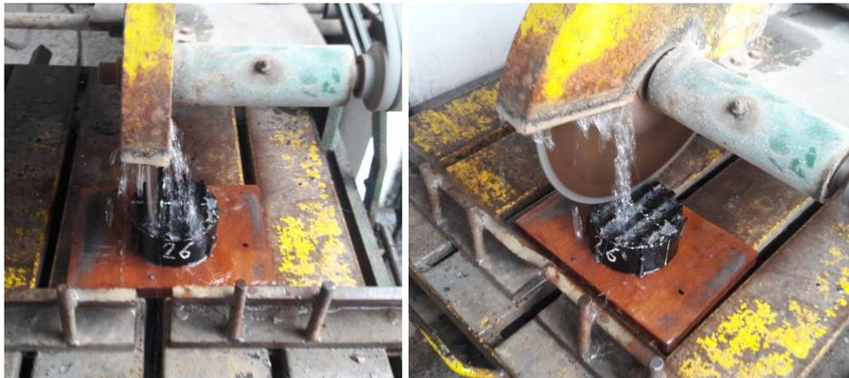
Figura 13. Aserrado de una probeta del Caso 5
