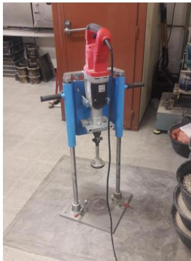
Figura 45. Equipo para la compactación de laboratorio
