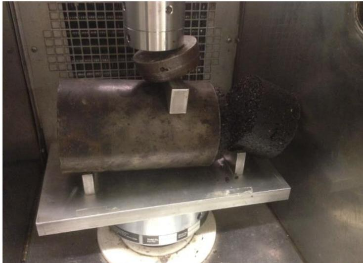
Figura 48. Probeta ensayada en el equipo LCB. Fuente: Christian Selk
