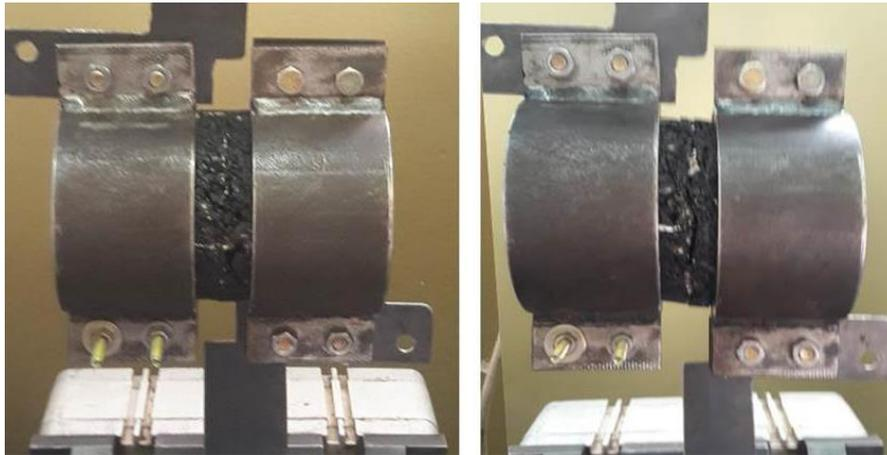
Figura 5. Deformación en zona central de la probeta doble durante el ensayo
