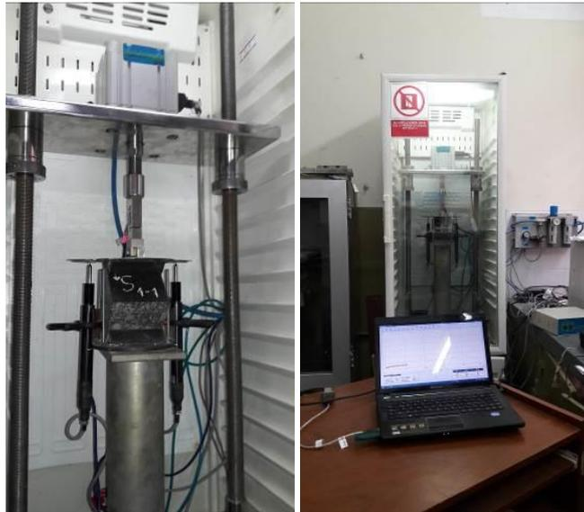
Figura 27. Imágenes durante el ensayo a fatiga de una de las probetas cúbicas
