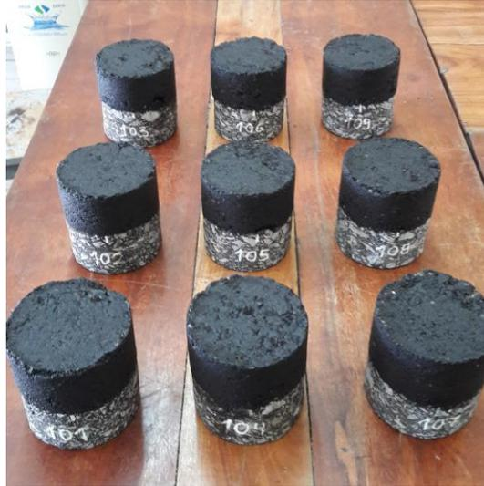
Figura 42. Probetas dobles moldeadas a partir de los testigos extraídos
