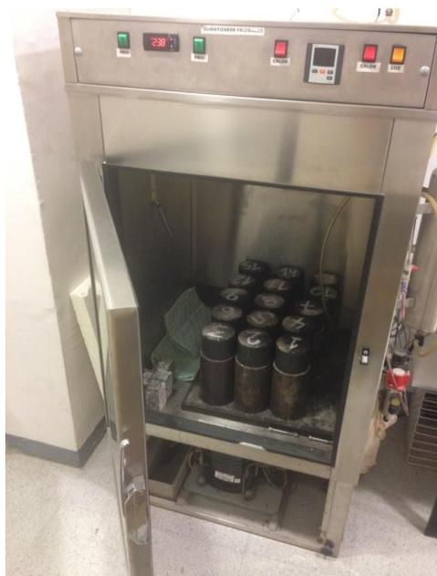
Figura 46. Probetas en acondicionamiento a 20 °C. Fuente: Christian Selk
