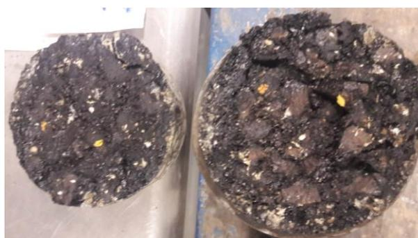
Figura 56. Probeta 8 ensayada, base (izq.) y revestimiento (der.)
