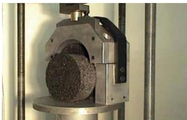
Figura 1. Máquina de ensayo SBT. Fuente: Montestrusque et al., 2015
