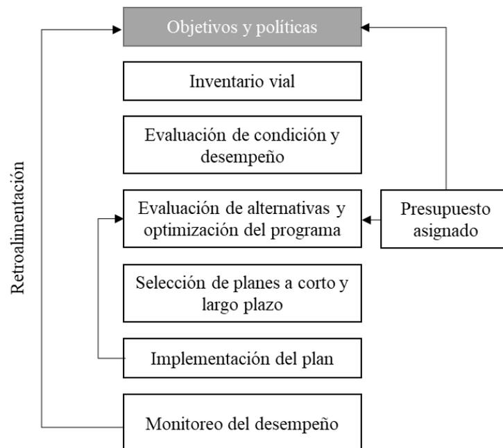
Fig. 1 – Esquema de un Sistema de Gestión de Pavimentos (FHWA, 1999).
