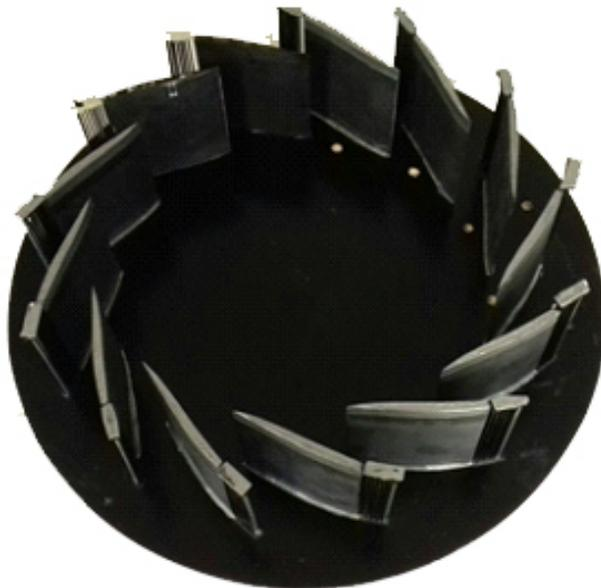
Los resultados obtenidos en simulación CFD fueron validados recientemente a través de ensayos realizados en laboratorio a un prototipo de 60 cm
