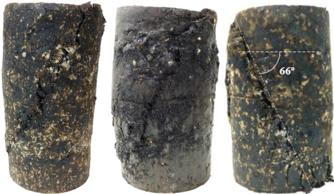
*Figura 3.15 Ejemplos de probetas rotas tras ensayo triaxial de deformación permanente*
