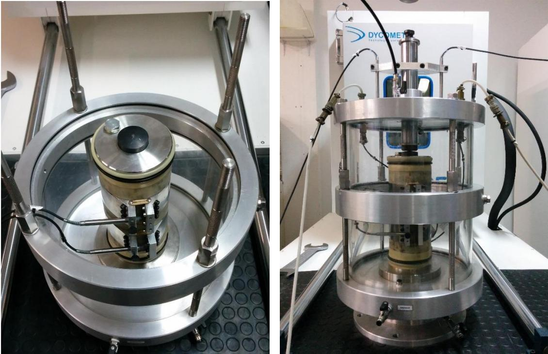
**Figura 2.7 Ensayo dinámico de rigidez con confinamiento triaxial según Norma UNE-EN 13286-7**
