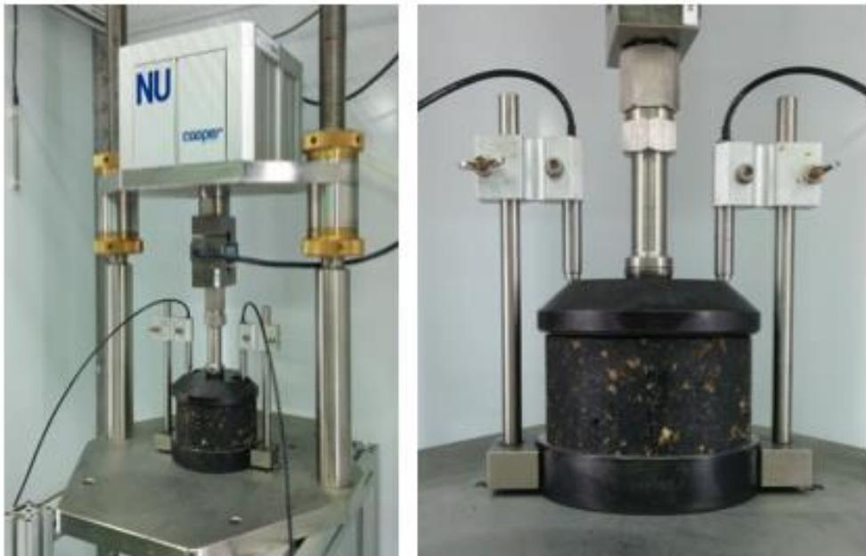
**Figura 2.5 Disposición del ensayo de deformación permanente según Norma BSi DD 226**
