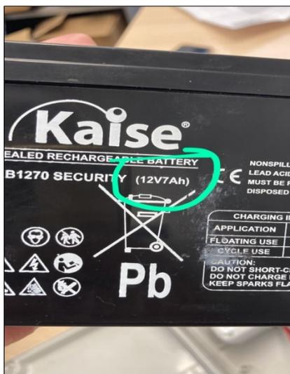
Figura 9: Batería 7 Ah/12v para almacenamiento de energía
