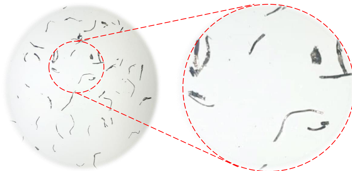
Figura 4. Fibras de acero utilizadas en la fabricación de los morteros.
